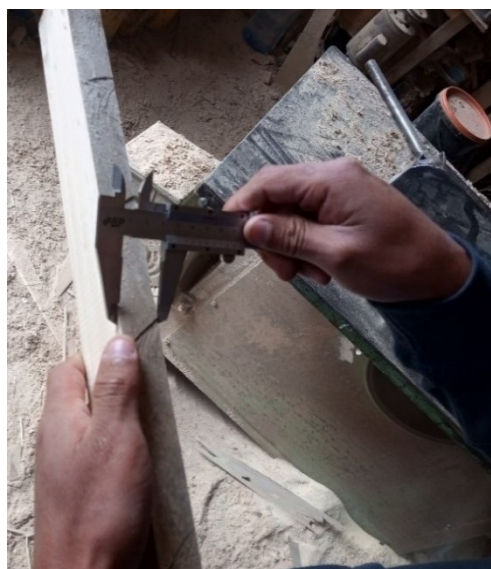
Fig. 27. Dimensiones normalizadas flexión.
