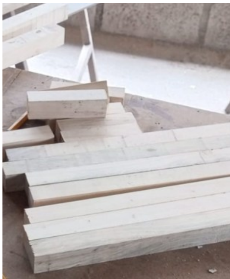
Fig. 9. Especímenes para densidad seca al aire, a una temperatura 23°C.
