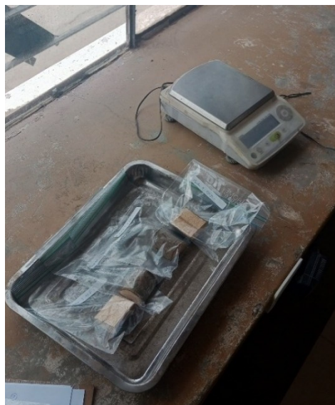
Fig. 29. Balanza electrónica con sensibilidad de 0.01 g.
