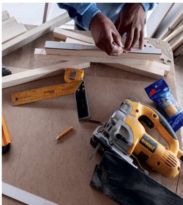
6. Señalar con molde de triplex
