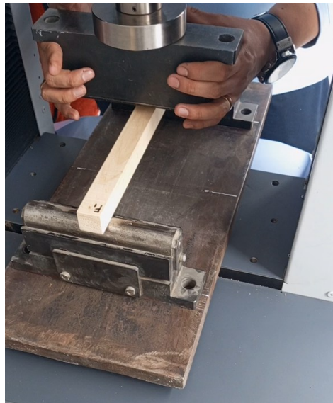
Fig. 52. Fijación de apoyos.
