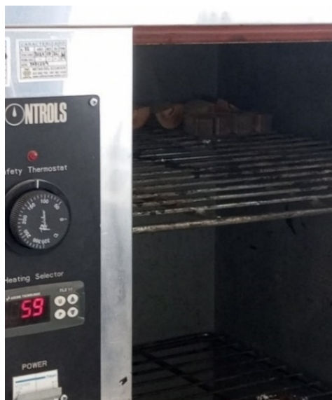
Fig. 31. Especímenes en el horno eléctrico a temperatura 103 \pm 2 °C.
