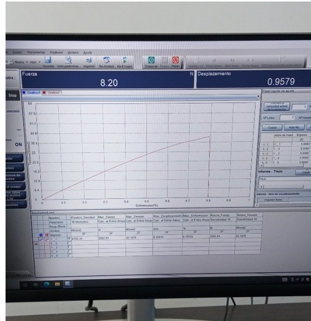
16. Curva Fuerza vs Desplazamiento
