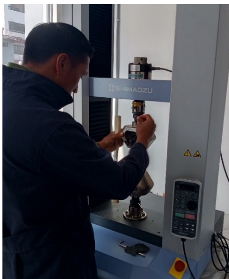
Fig. 38. Colocación de mordazas.
