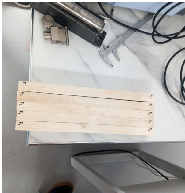
2. Probeta de ensayo (2.5x2.5x41 cm)
