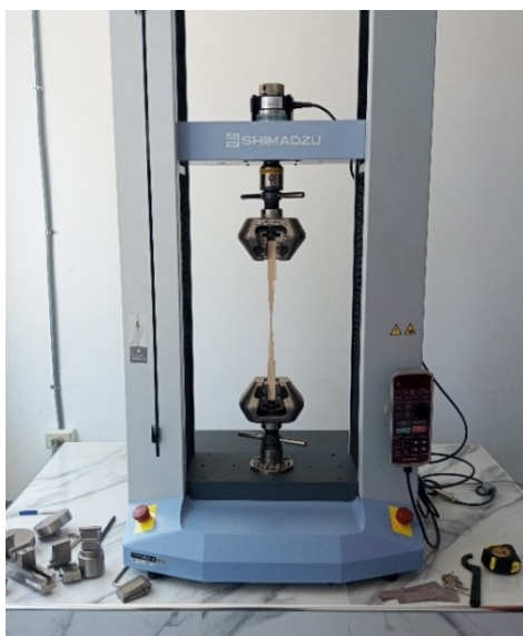
Fig. 10. Ensayo a tracción paralela a la fibra.
