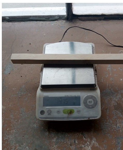
Fig. 36. Peso de especímenes seca al aire (flexión).
