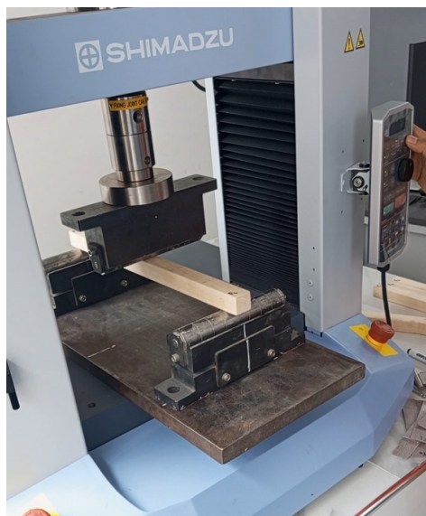
Fig. 57. Registro de fuerza y desplazamiento.
