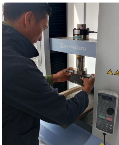
Fig. 56. Centrado de carga en probetas.
