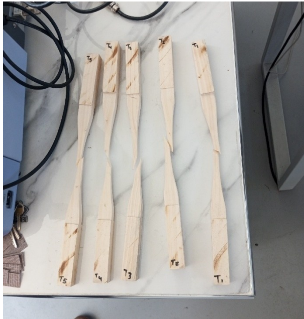
15. Probeta ensayada con fractura
