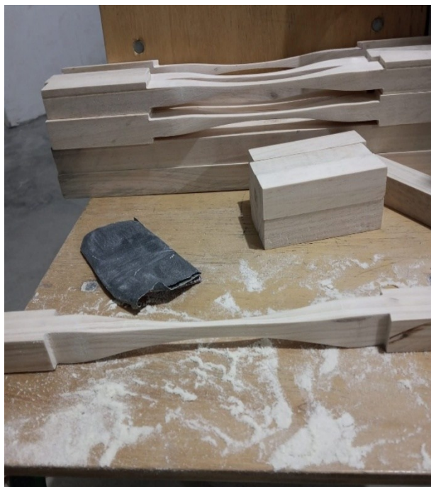
9. Lijado del centro de probeta
