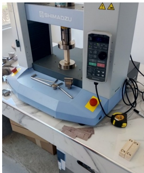
Fig. 11. Ensayo a compresión paralela a la fibra.
