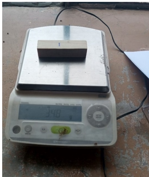
Fig. 35. Peso de espécimen seca al aire (compresión).
