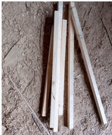
Fig. 22. Flejes para las probetas de compresión paralela a la fibra.
