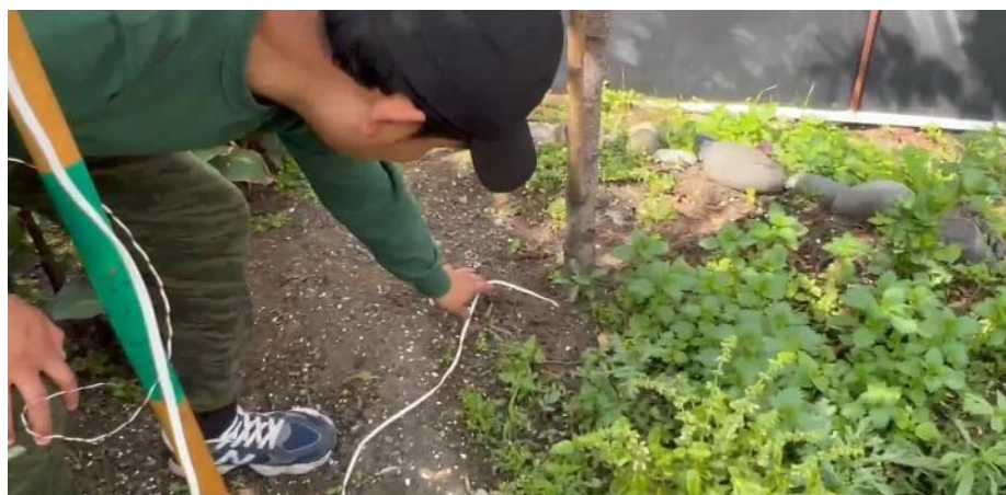
Figura F3. Colocación de los electrodos para la obtención de energía de la planta.
