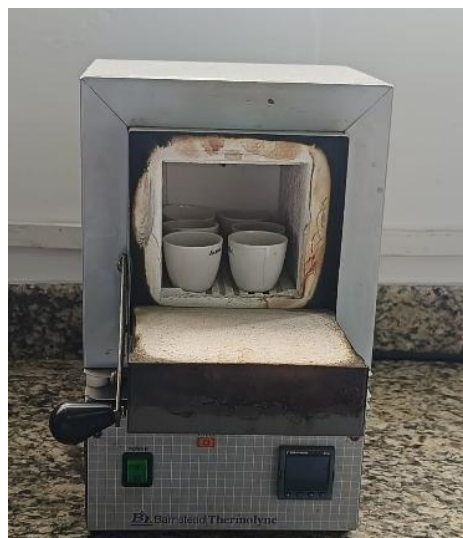
Figura 11. Determinación de cenizas insolubles en HCl.
