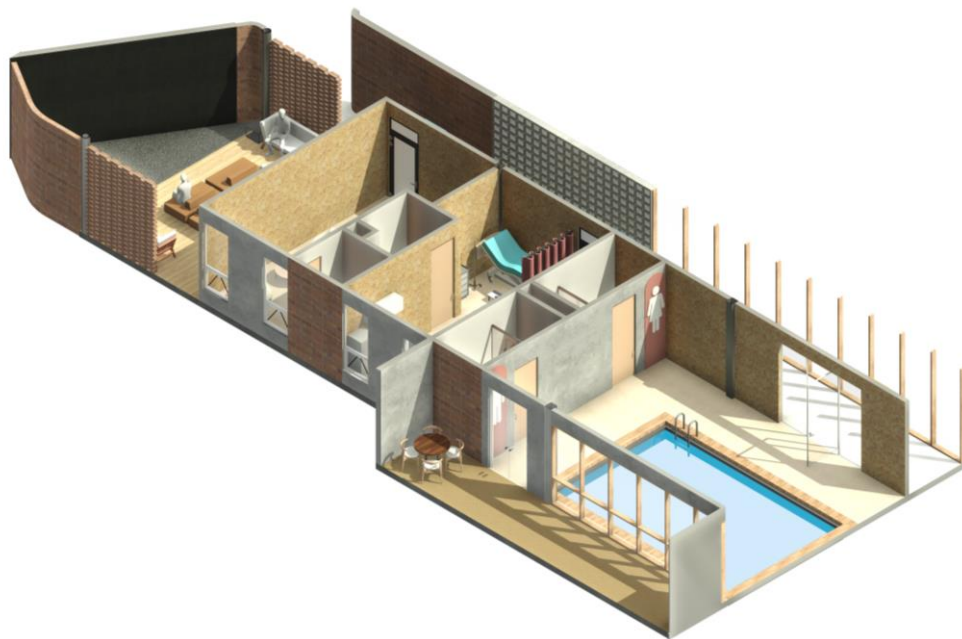
Figura 119. Axonometría del Área Médica y Piscina (Elaboración Propia, 2024).
