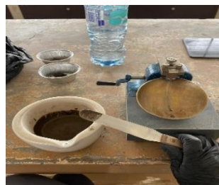
Fig. 4. Pasta homogénea para límite líquido
