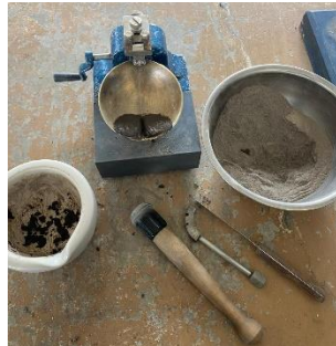
Fig. 6. Muestra de suelo acanalada en la copa de Casagrande
