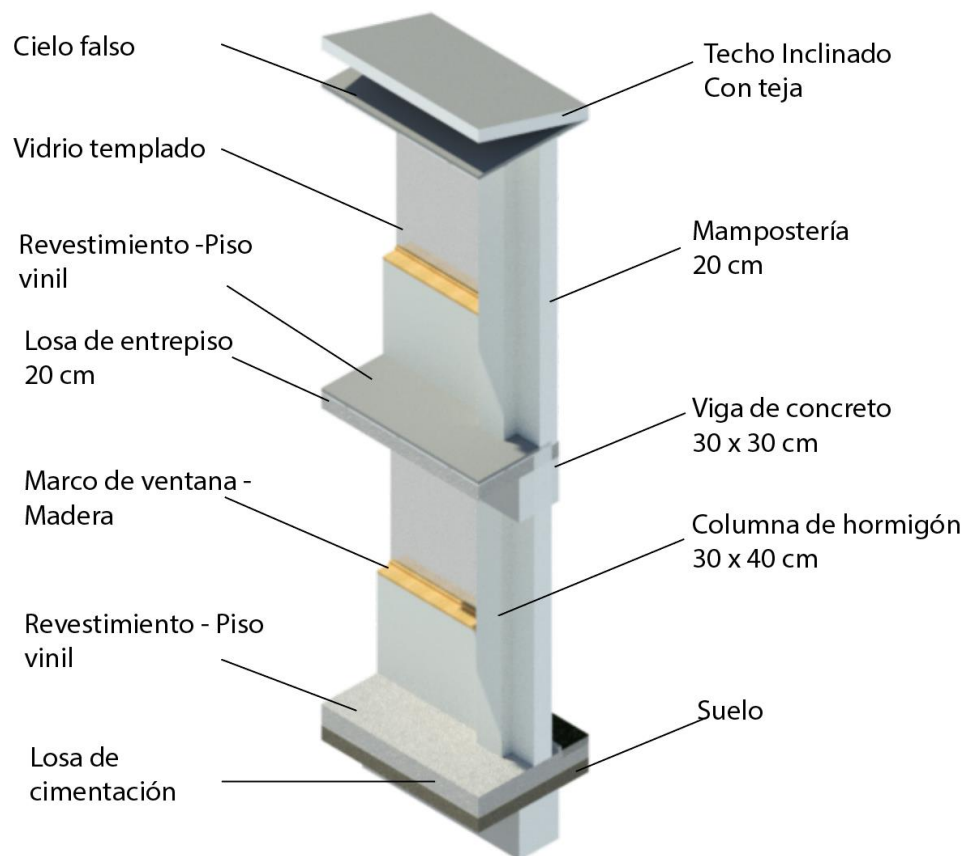
Figura 57. Detalle – Estructura Hormigón Armado. Elaboración propia. (2025)
