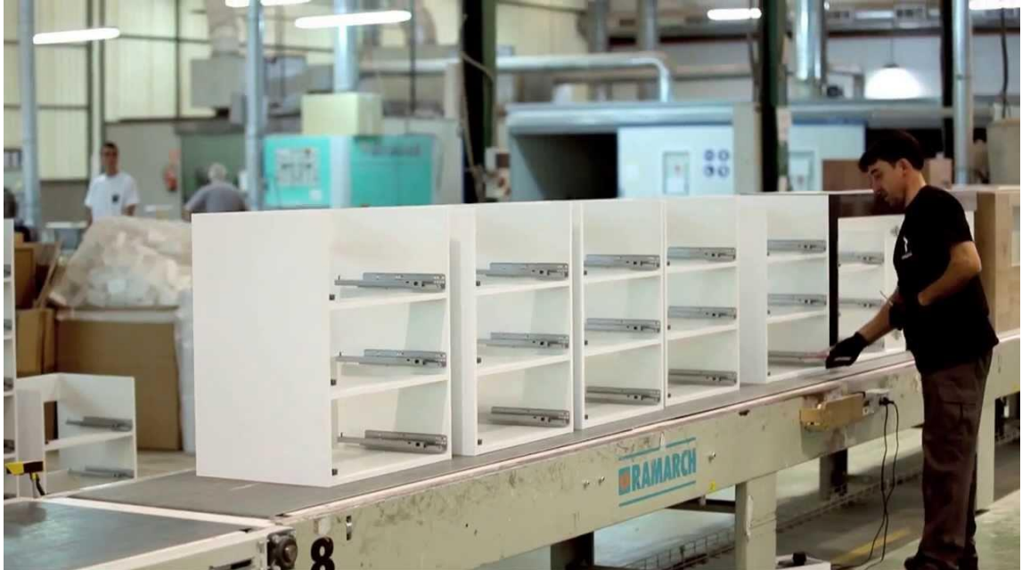
Imagen 17: Producción en serie de gabinetes para baño. Fuente: TORVISCO GROUP, 2012
