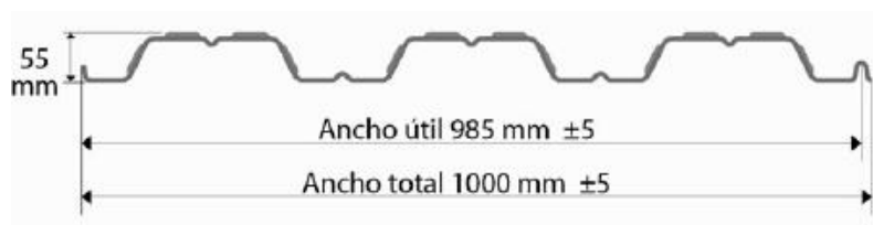
Figura 6. Perfil placa colaborante
