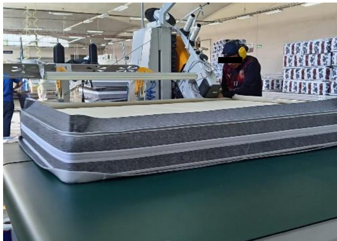
Figura 28. Proceso de cerrado de bandas en colchones clínicos.
