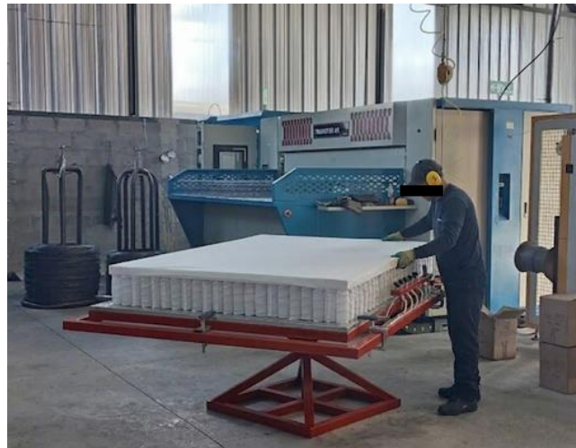
Figura 10. Fabricación de paneles para la línea Pocket Coil.
