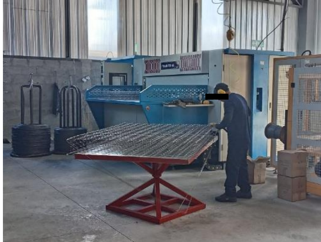
Figura 11. Fabricación de paneles con resortes clásicos.
