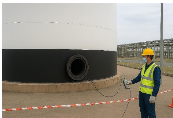
Figura 27. Control de atmósferas peligrosas
