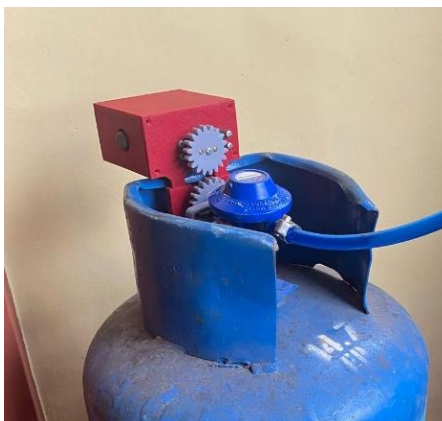
Figura 57. Sistema de control y monitoreo de GLP instalado en el cilindro
