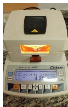
Determinación de humedad de las mezclas en polvo
