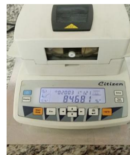
Determinación de la humedad de la pulpa
