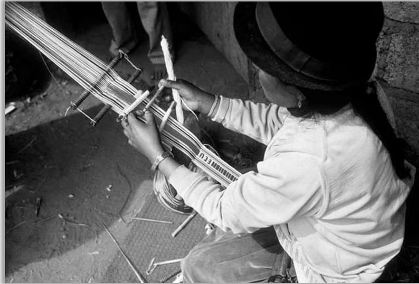
Figura 10. Patrón de un telar de cintura, los hilos de urdimbre suplementarios son controlados por una segunda varilla de batida. Área al oeste de Salcedo, provincia de Cotopaxi, Diapositiva de George Crockett, 1988.
