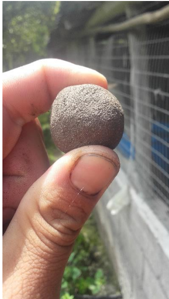
Ensayo de la bolita de barro
