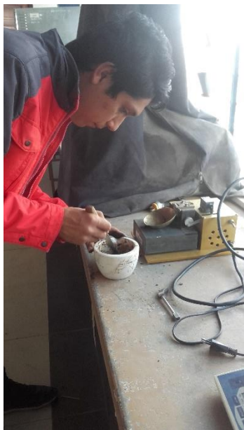
Ensayo Copa de Casagrande para determinar el límite líquido
