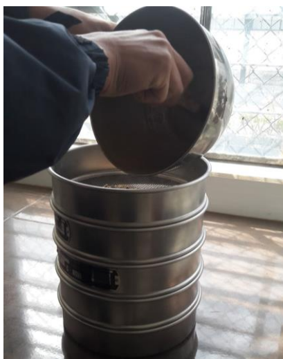
Elaboración del ensayo de granulometría.
