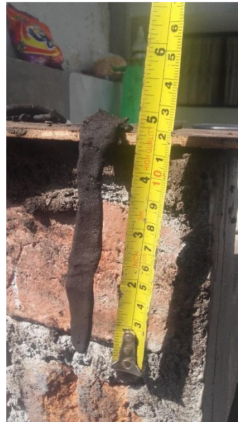
Ensayo de cinta de barro.
