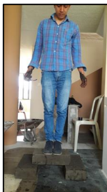
IMAGEN 16: Prueba “Resistencia de los bloques de adobe”
