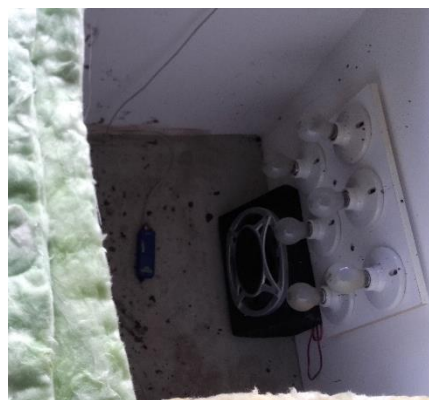
Fuente de sonido y temperatura para ensayo acústico y térmico.
