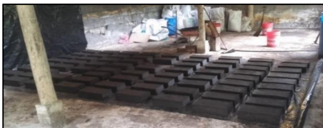
IMAGEN 14: Muestras de adobe elaboradas artesanalmente para ensayo acústico y térmico
