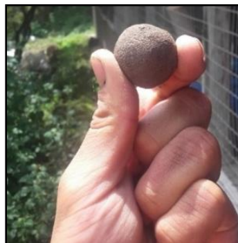
IMAGEN 11: Prueba “Presencia de arcilla” o “Resistencia seca”
