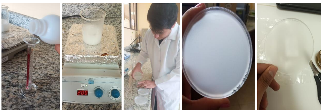
Figura 2. Proceso de generación de las biopelículas de melloco. Se muestra el caso de la variedad amarilla, como ejemplo.
