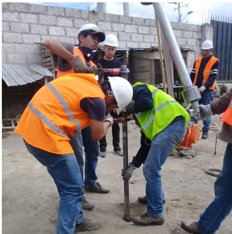
Fotografía 3 Extracción de la cuchara partida
