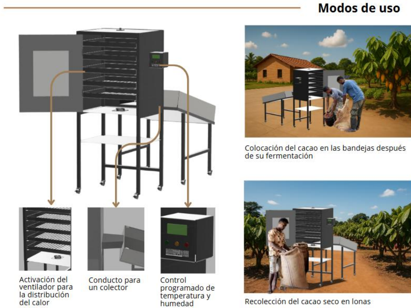
Figura 33. Modos de uso de la máquina de secado de cacao.
