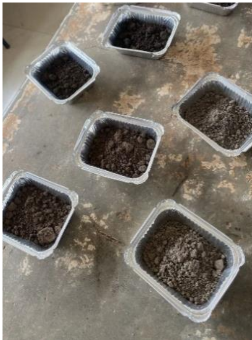
Fig. 4 Ensayo contenido de Humedad
