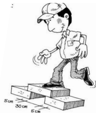
Fig. 37. Prueba de la resistencia del bloque de adobe
