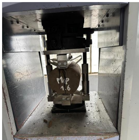
Fig. 39. Prueba de la resistencia a tracción indirecta del cilindro de adobe
