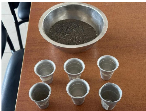
Fig. 4. Equipos y materiales para Contenido de Humedad
