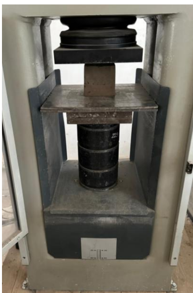
Fig. 38. Prueba de la resistencia a compresión del cubo de adobe
