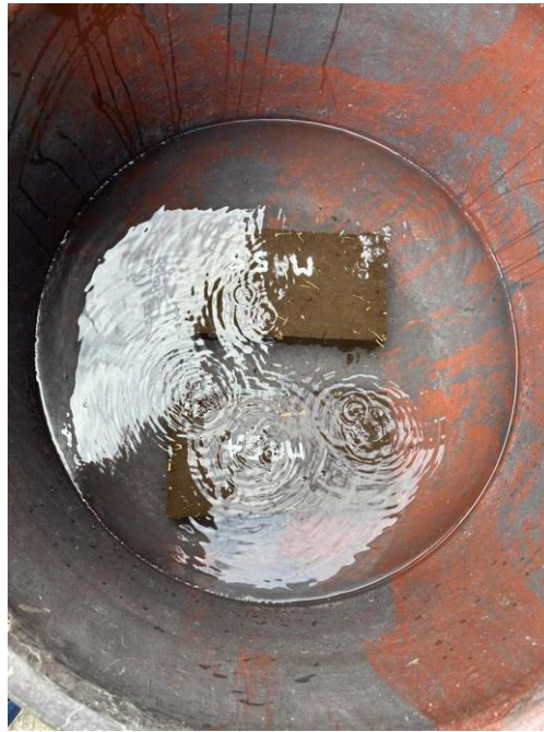
Fig. 41. Prueba de la absorción del bloque de adobe
