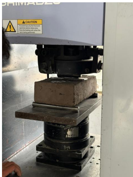
Fig. 40. Prueba de la resistencia a flexión del bloque de adobe
