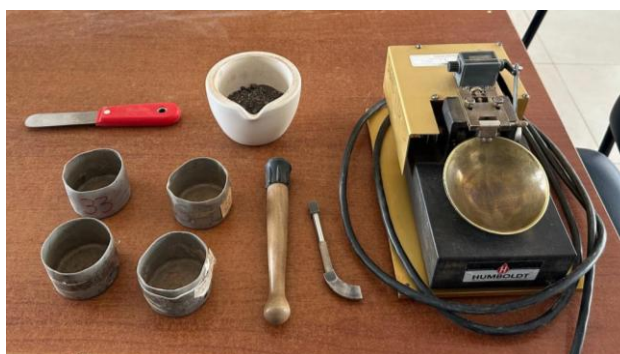
Fig. 7. Equipos y materiales para Límite Líquido
