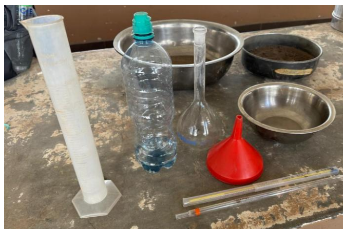
Fig. 10. Equipos y materiales para Gravedad Específica del Suelo
