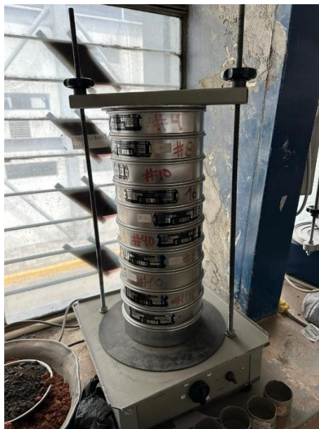
Fig. 6. Equipos y materiales para Granulometría
