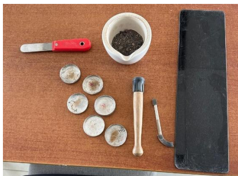
Fig. 8. Equipos y materiales para Límite Plástico
