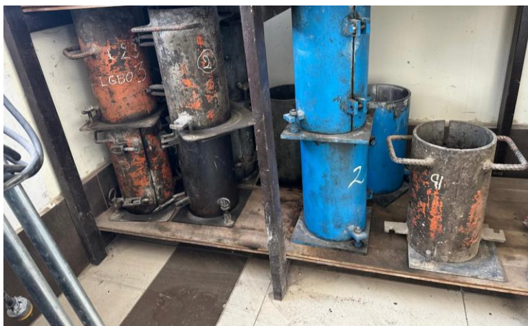
Fig. 29. Moldes cilíndricos para el ensayo a tracción indirecta
