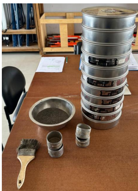
Fig. 5. Equipos y materiales para Granulometría
