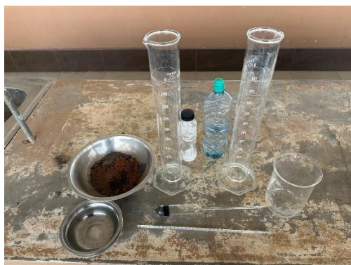
Fig. 9. Equipos y materiales para Granulometría por Hidrómetro
