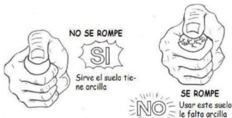
Fig. 27. Prueba de resistencia seca [22]
