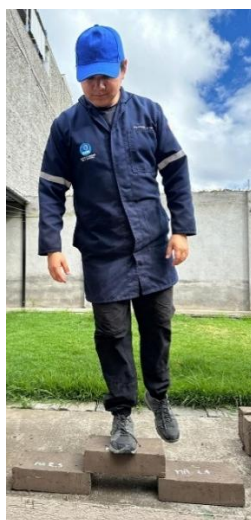
Fig. 56. Prueba de la resistencia del bloque de adobe
