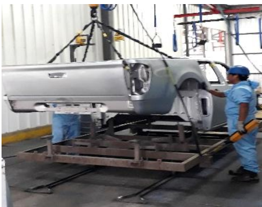
Figura 59. Alineación de unidad con dollie
