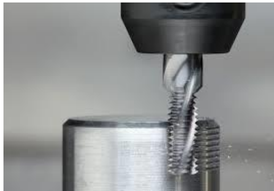
Figura 9. Proceso de roscado. Fuente: [27]
