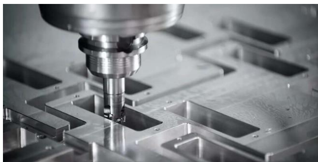
Figura 6. Proceso de fresado. Fuente: [23]
