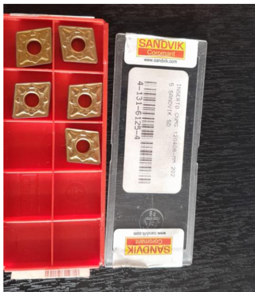
Figura 17. Inserto CNMG 120404 MF 2025 para los ensayos de torneado.
