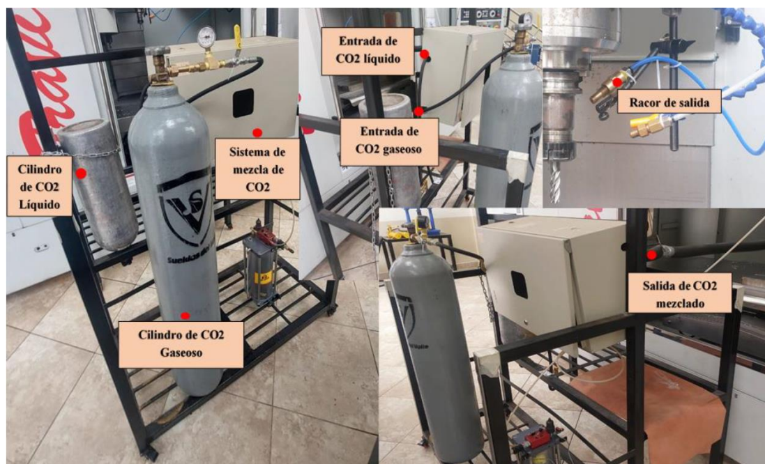
Figura 26. Sistema criogénico trabajado en los ensayos de fresado. Fuente: [19].
