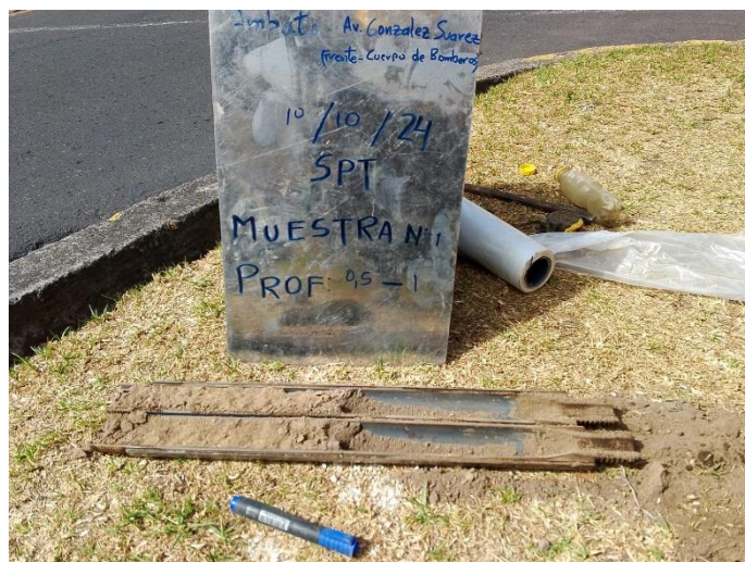
Fotografía 3 Muestra Perforación S.P.T. 1
