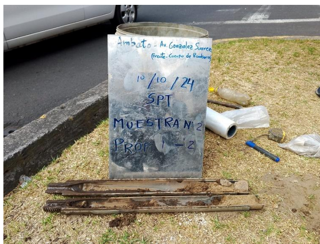
Fotografía 4 Muestra Perforación S.P.T. 1
