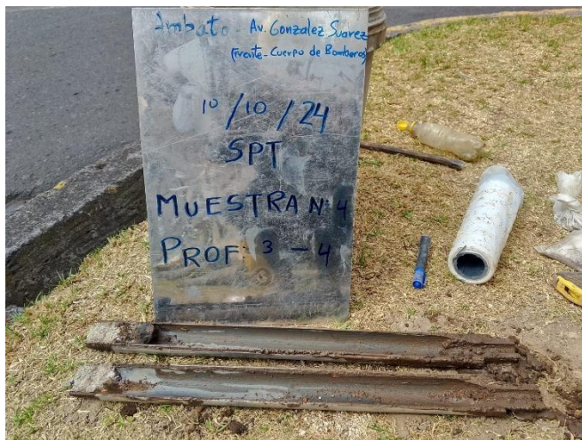
Fotografía 6 Muestra Perforación S.P.T. 1
