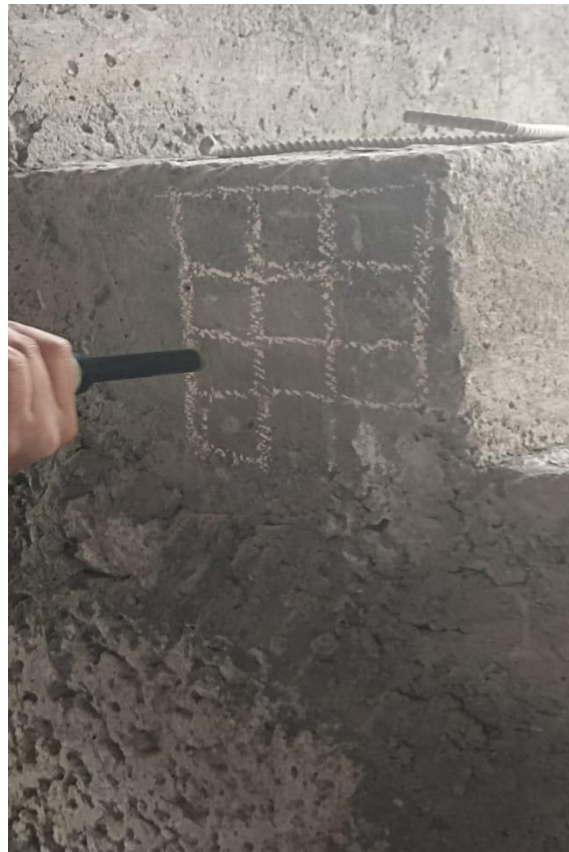
Ilustración 3. Ensayo esclerométrico a gradas
