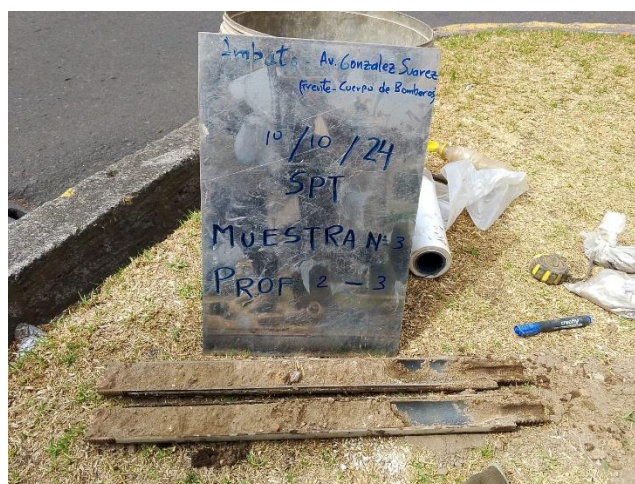
Fotografía 5 Muestra Perforación S.P.T. 1
