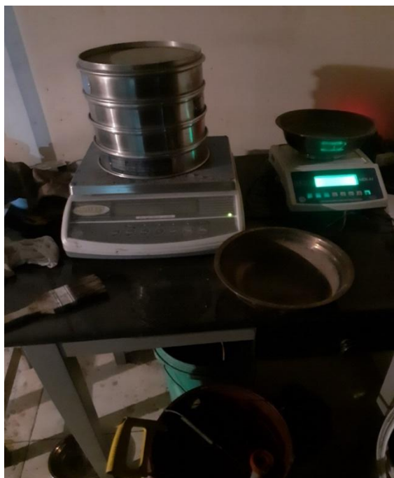
Fotografía 7 Granulometría de material del suelo
