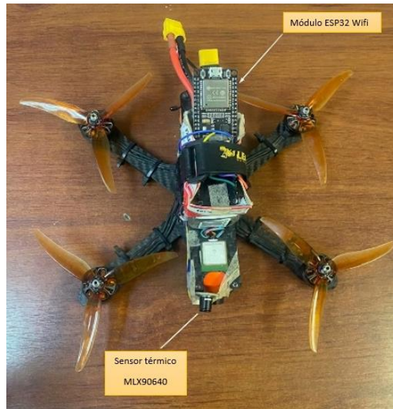
Figura 54. Implementación del sensor térmico MLX90640 y ESP32 en el UAV.
