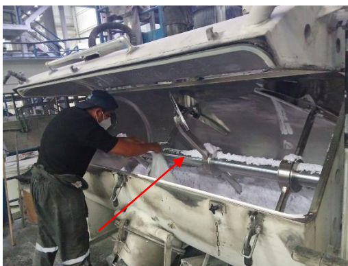
Figura 14 Riesgo de corte aspas de enfriador
