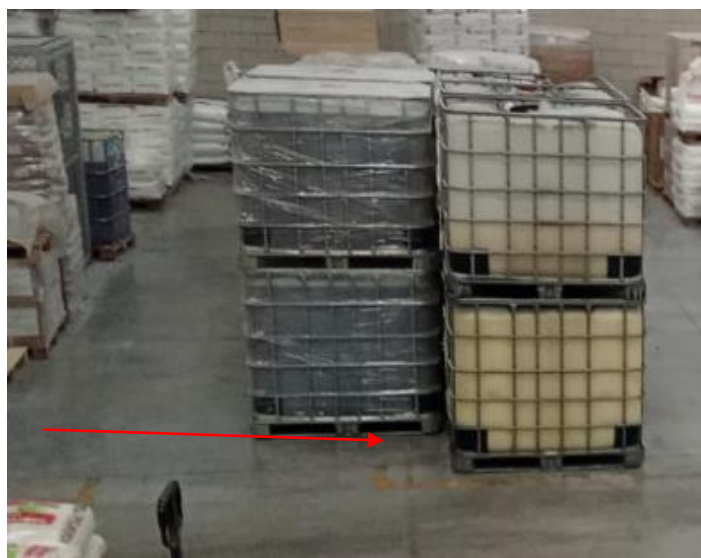
Figura 17 Riesgo de aplastamiento tanque IBC
