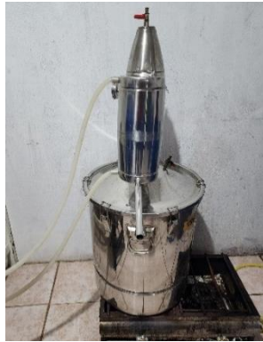
Figura 33 Alambique de 70 L de capacidad
