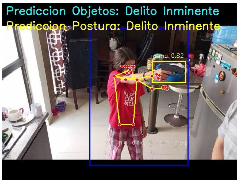
Figura D6. Detección en entorno controlado con dibujo de postura activada y etiquetas impresas en fotograma.
