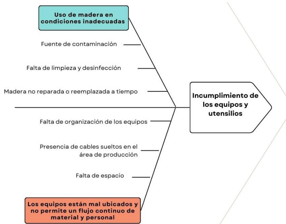
Figura 23. Inconformidades encontradas en la microempresa de embutidos “Bango”, equipos y utensilios.
