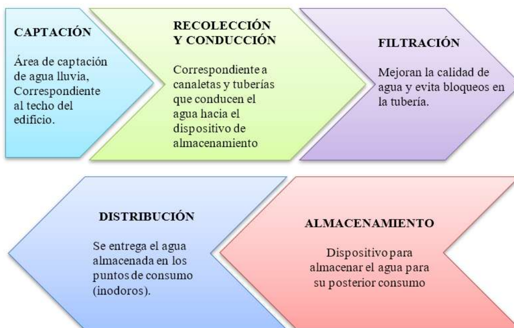
Fig. 1 Componentes del SCALL
