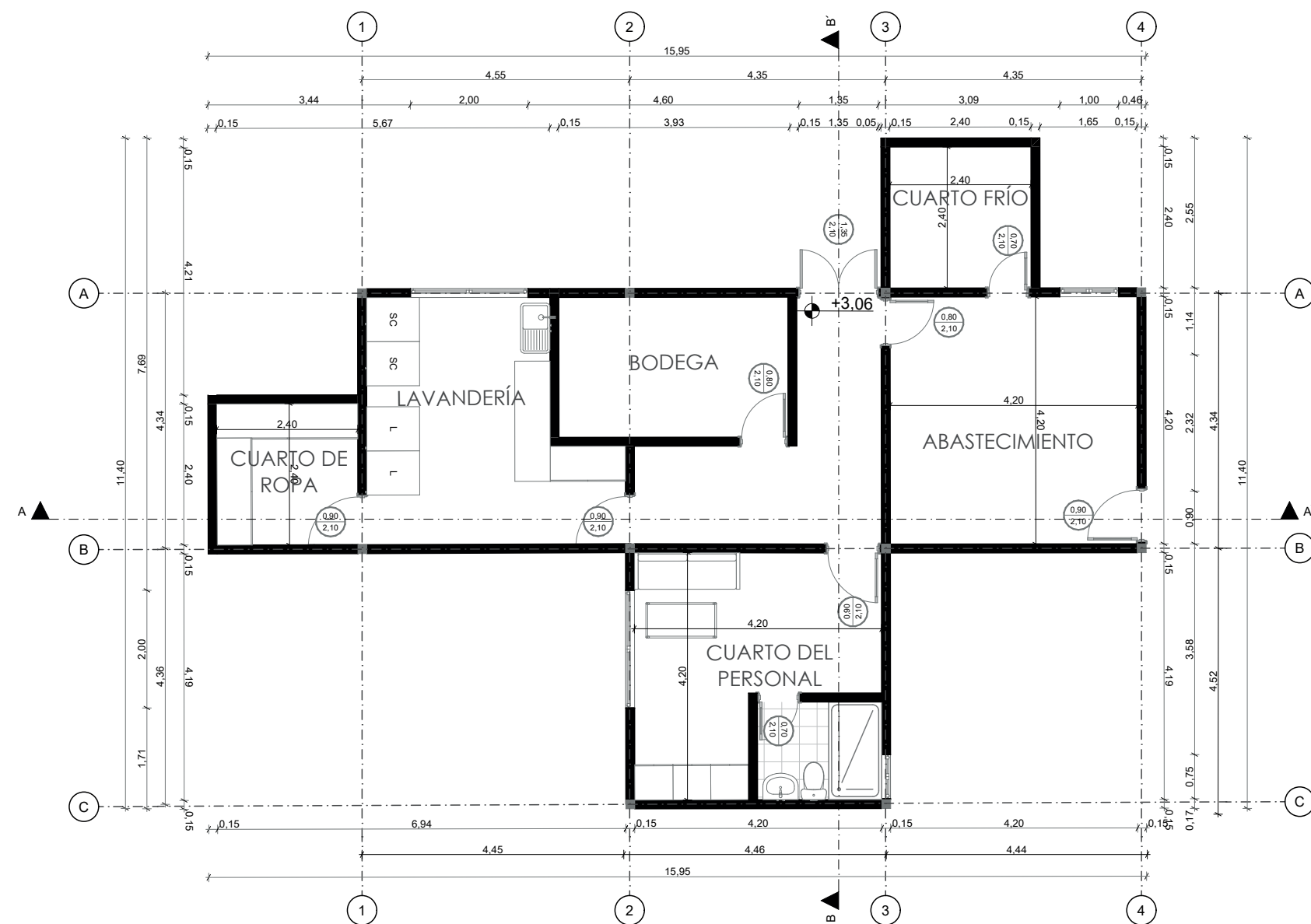
Planta baja- modulo de servicio
