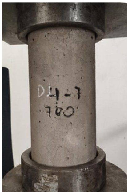
Fig. 4. Ensayo de compresión.
