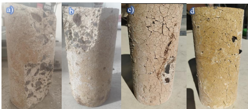
Fig. 13. a) Degradación avanzada D1, b) Spalling moderado D2, c) Spalling Leve D4, d) Fisuras Avanzadas D5
