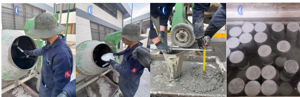
Fig. 7. (a) Adición de aditivo Incorporador de Aire, (b) Adición de las Macrofibras de Polipropileno, (c) Control de Asentamiento, (d) Curado de Probetas.
