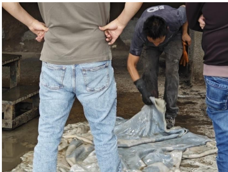
Figura 21. Inspección para recurtido y recromado.
