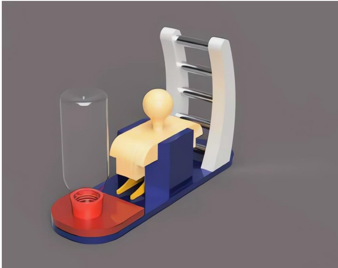
Figura 11. Herramienta para colocar canto en tableros de melamina en talleres artesanales
