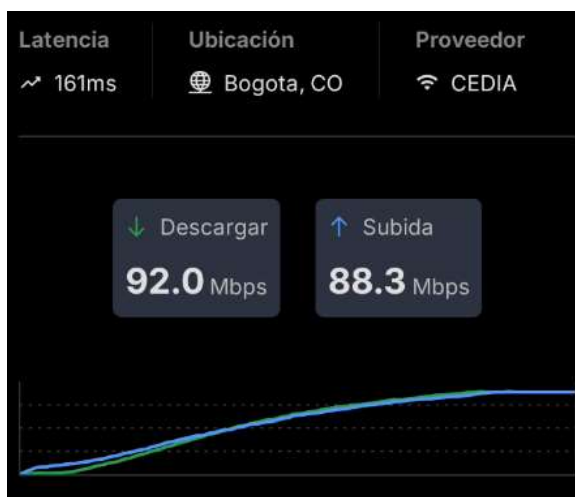
Figura 44. Prueba de velocidad mediante el enlace inalámbrico dedicado propuesto.
