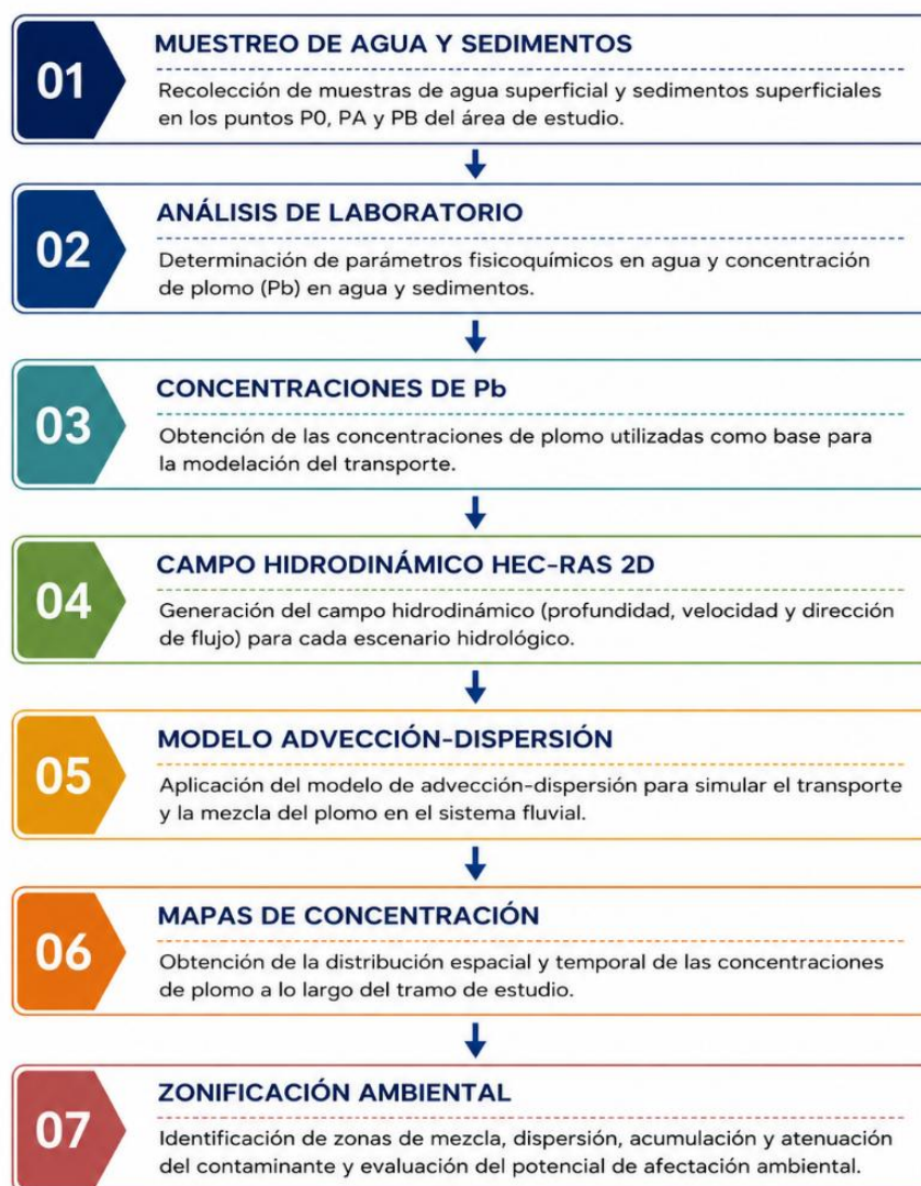
Figura 9. Esquema metodológico para la evaluación y modelación del transporte de plomo (Pb) en el sistema hídrico Yurasyacu–Anzu
