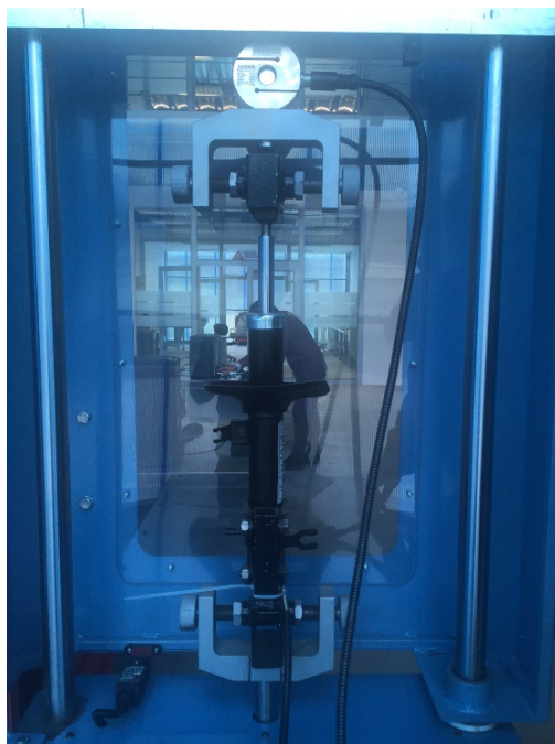
Figura 3.4. Banco de pruebas para amortiguadores Dyno-Shock 11.
