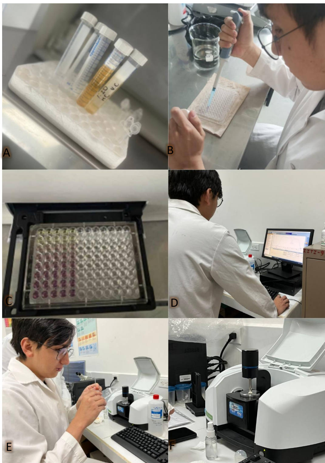
Figura 10 A; Disolución 1:10 y 1:20 para AF microencapsulado. B; Preparación de la placa de 96 pocillos. C; Análisis por espectrofotometría UV VIS. D; Preparación y Homogeneización de muestra para análisis FTIR. E y F; Análisis infrarrojo de todos los componentes de la bebida en polvo y AF microencapsulado.
