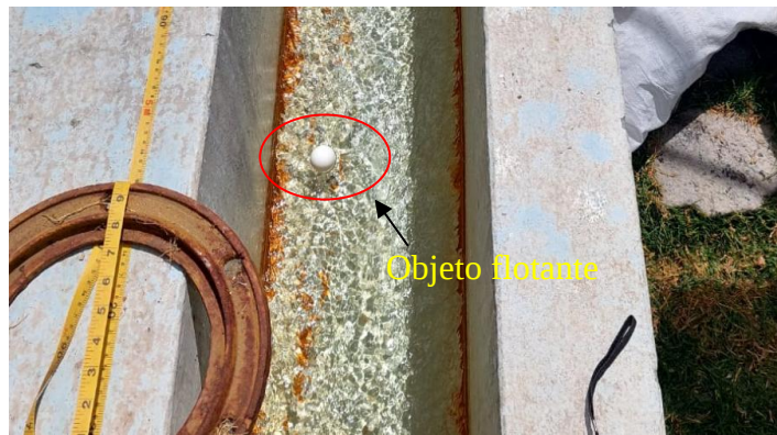
Figura 6. Objeto flotante empleado para medir la velocidad del fluido
