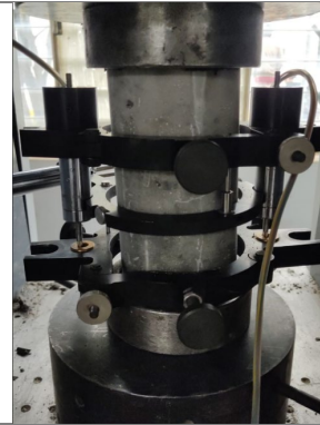
Descripción: Ensayo de Módulo elástico de hormigón con 8% de microsilíce.
