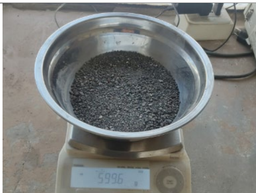
Descripción: Muestra seca del agregado fino.
