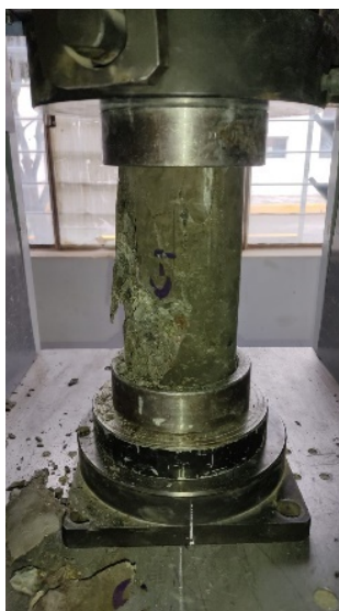
Fig. 9. Ensayo a compresión.
