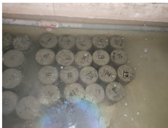
Fig. 8. Curado de probetas de hormigón.
