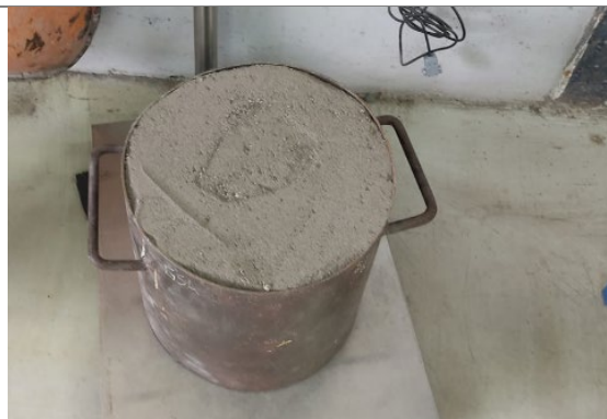
Descripción: Ensayo de compactación del agregado fino.
