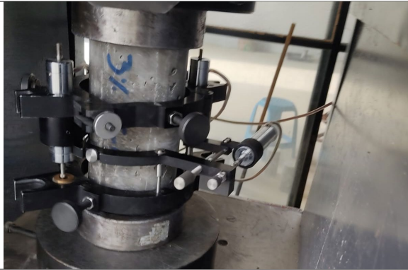
Descripción: Ensayo de Módulo elástico de hormigón con 3% de microsilíce.
