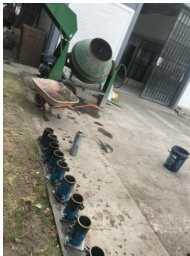
Fig. 3. Elaboración de probetas de hormigón.
