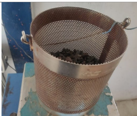
Descripción: Densidad real del agregado grueso.
