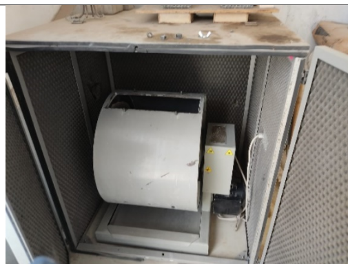
Descripción: Ensayo de abrasión del agregado grueso.
