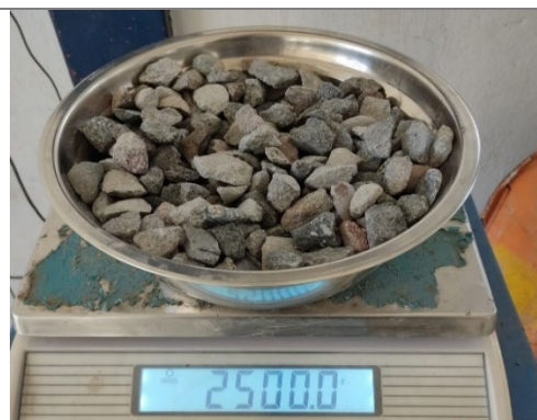
Descripción: Muestra seca del agregado grueso.
