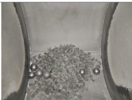
Descripción: Ensayo de abrasión del agregado grueso.
