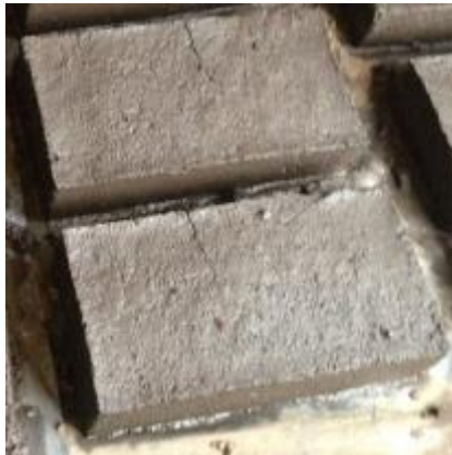
Figura 5. Presencia de arcilla en los bloques de adobe.
