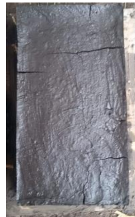
Figura 5. Presencia de arcilla en los bloques de adobe.
