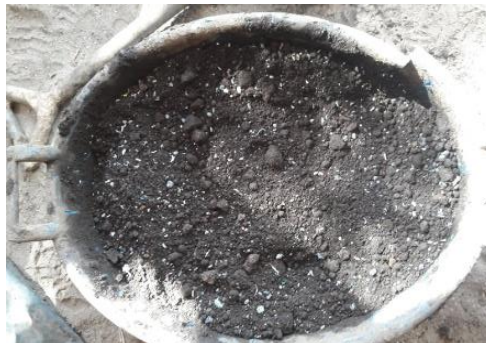
Figura 12. Barro reposado más agregado de bolsas plásticas.
