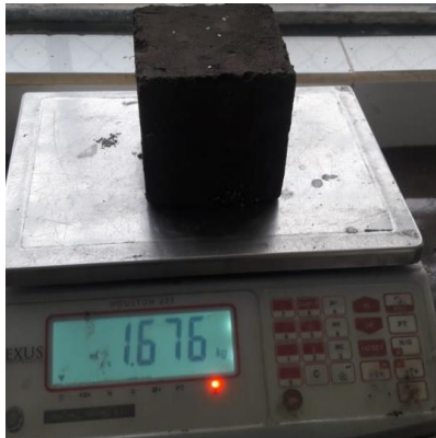
Peso de la unidad de adobe para el ensayo a compresión
