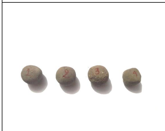
Figura 3. Cuatro muestras secas para la prueba de presencia de arcilla.
