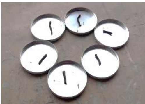
Figura 25. Filamentos para determinar el Límite plástico.
