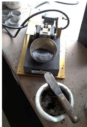
Figura 24. Muestra colocada en la cuchara de Casagrande.
