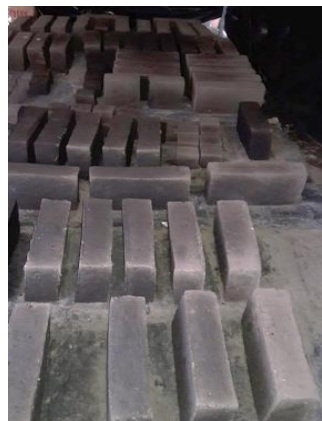
Figura 14. Secado y apilado de los bloques de adobe.
