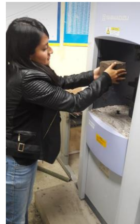
Ensayo a compresión de los bloques de adobe
