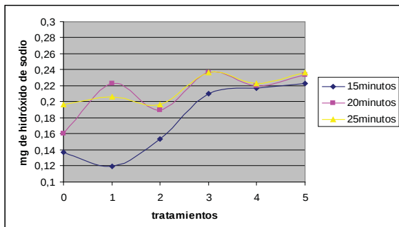
Figura 3 Fideos obtenidos a partir de diferentes mezclas farináceas vs. mg de NaOH, necesarios para neutralizar la acidez en fideo, a tres diferentes tiempos de precocido.
