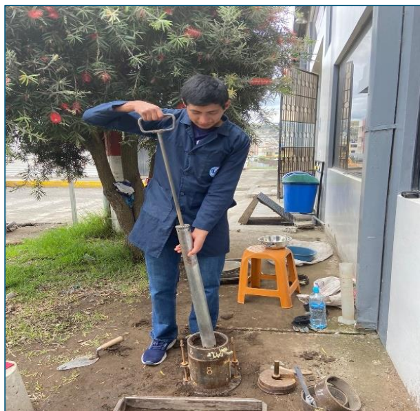
Figura 9. Compactación del material granular.
