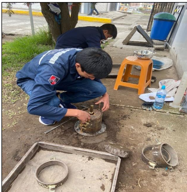
Figura 12. Colocación de pesas en el molde
