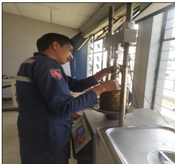
Figura 14. Ensayo de CBR en la Máquina Universal.
