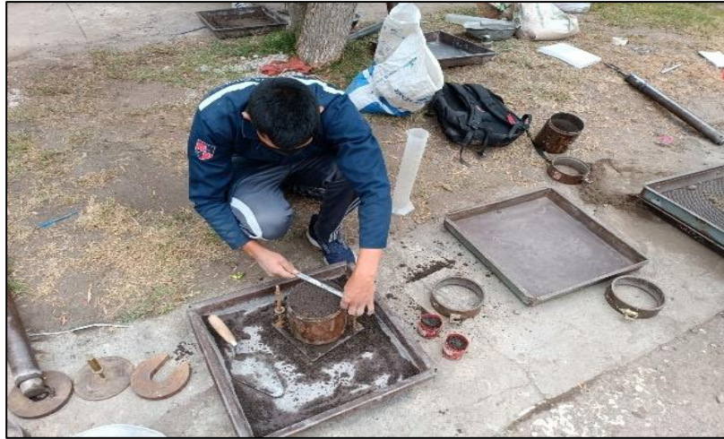
Figura 10. Enrazado del exceso del material.
