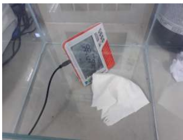
Figura 33. VOC muestra con acabado
