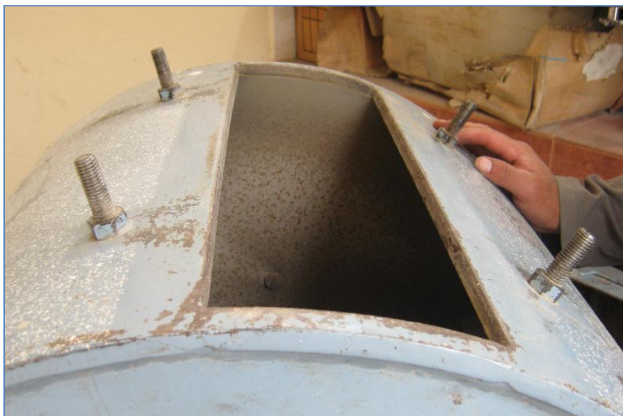
Figura 6.43. Pernos colocados cerca de los 4 extremos de la abertura para sujetar la tapa del cilindro.
