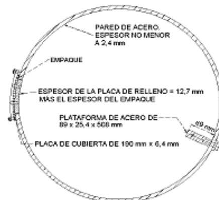
DISEÑO DE PLATAFORMA DE PLACA DE CUBIERTA
