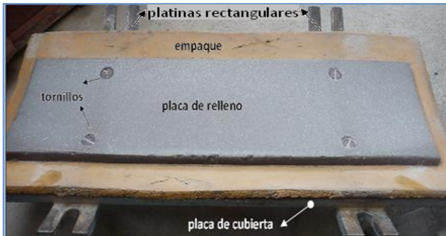
Figura 6.45. Esquema de las partes constitutivas de la tapa (vista de frentes desde el interior) del cilindro.
