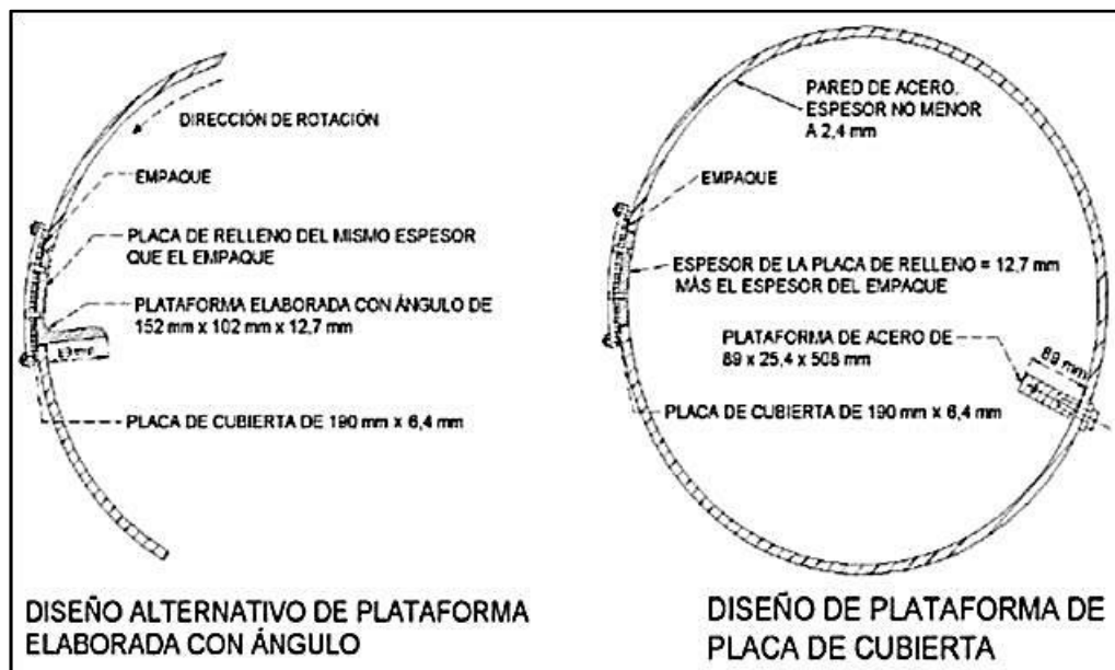
Figura 4.1. Plataforma de la Máquina de los Ángeles según INEN 860.
