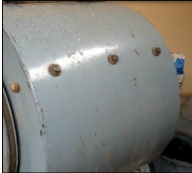
Figura 6.38. Disposición de perno para el acople de la plataforma con el cilindro.
