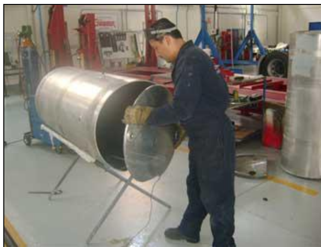
Figura 6.39. Obrero uniendo tapas de tanque.
