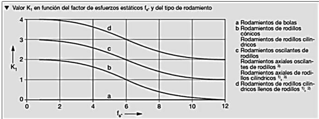
Figura 6.25. Valor de K_1 en función del factor de carga ( f_s ) y el tipo de rodamiento.
