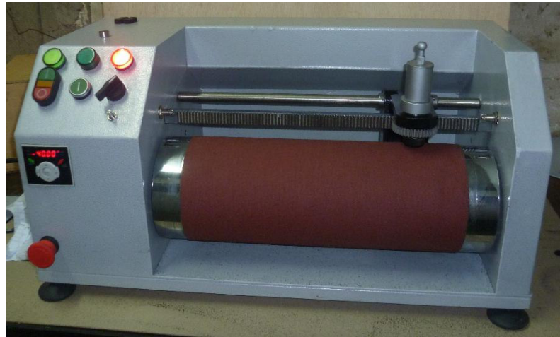
Imagen 4.7 Banco de pruebas del ensayo de abrasión
