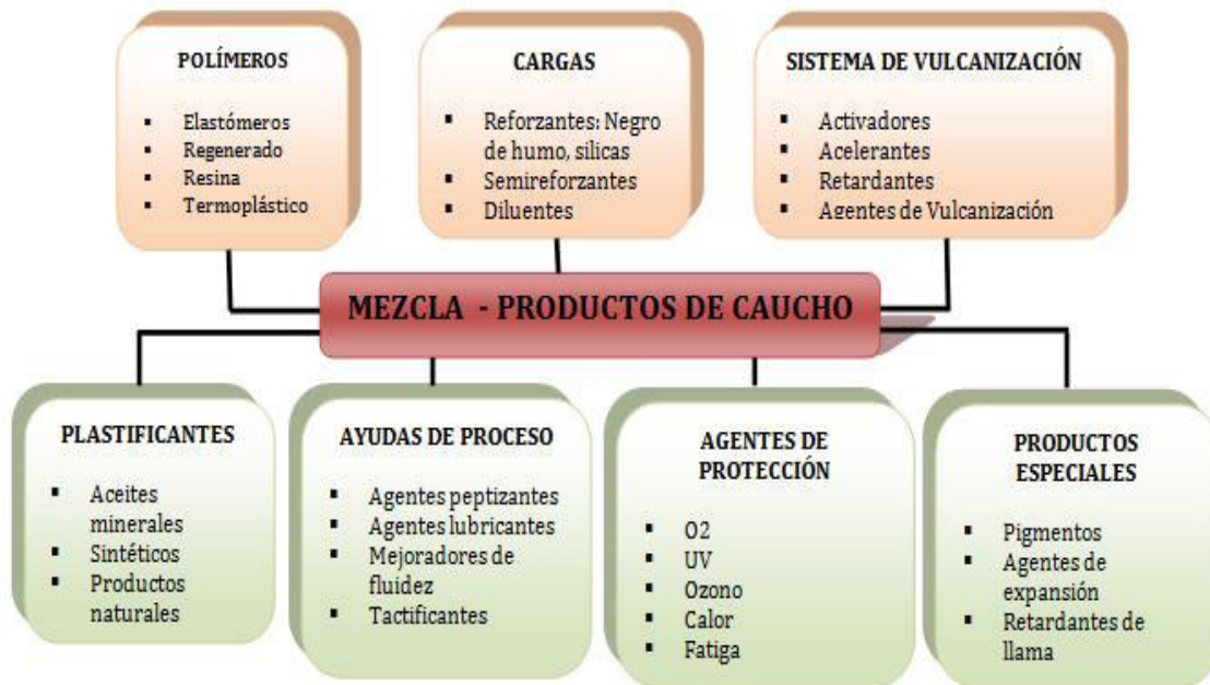
Figura 2.2 Compuestos empleados en un producto de caucho
