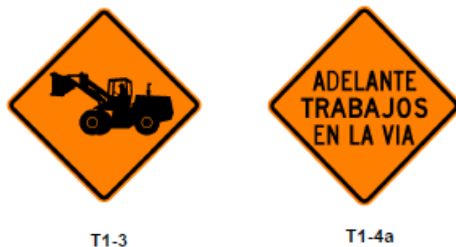
Figura No. 35 Señales y dispositivos para trabajos en la vía
