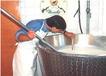
En la cuba, que es del tipo doble fondo cerrada, con un circuito de agua caliente, se vacía la leche y se calienta hasta la temperatura de pasteurización, a **65°C por 30 minutos**, es un proceso que se hace en forma intermitente, por lotes. Se le conoce también como pasteurización lenta y es el método ideal para los queseros en empresas pequeñas porque los volúmenes de leche son moderados y porque el procesamiento por
