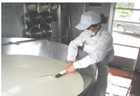
La coagulación es la solidificación de la leche debido a la precipitación de la caseína por acción de la enzima, renina o quimosina, del cuajo que ataca a las cápsulas de la caseína de la leche (proteína soluble) y la descompone para facilitar la unión con el calcio, formando paracaseína insoluble que precipita formando la cuajada. (Dubach, 1980)
