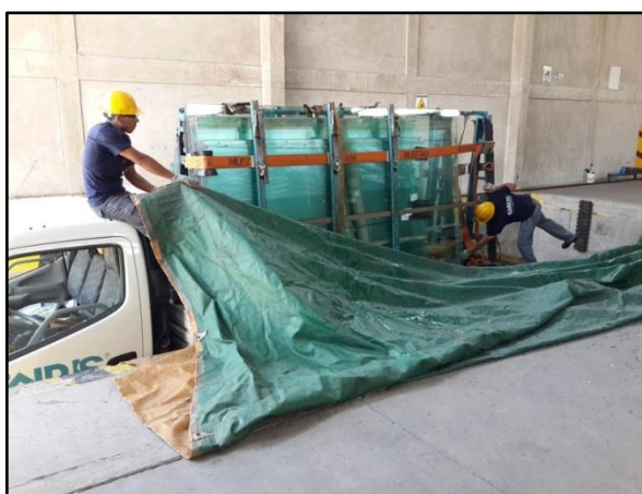
Fig. 46: Colocación de la carpa (1).
