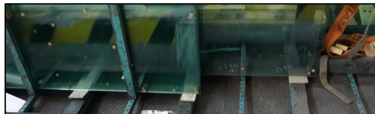
Fig. 41: Colocación de cartones en el piso.
