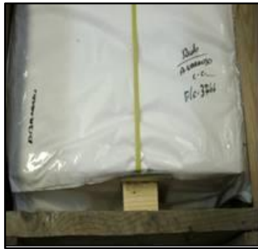
Fig. 26: Aseguramiento de la caja con tacos de madera
