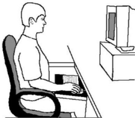
Ilustración 18: Solución a la postura forzada, el ratón al mismo nivel del teclado
