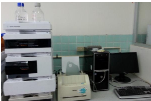
Fotografía G 1 Cromatógrafo Líquido de Alta Resolución Agilent 1200 series acoplado a detector UV/Visible.
