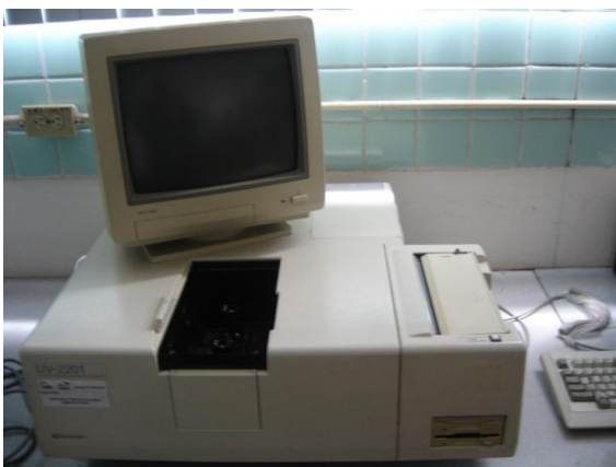
Fotografía G 3 Espectrofotómetro UV- VIS Shimadzu.
