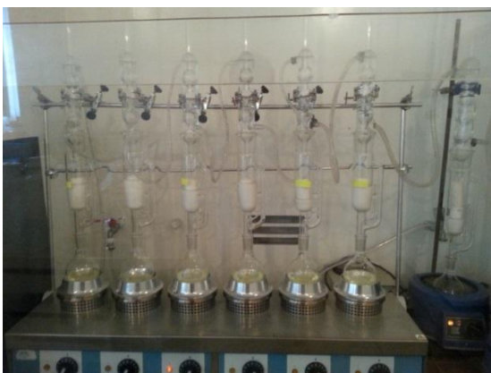
Fotografía G 2 Equipo de extracción de grasa Soxhlet.
