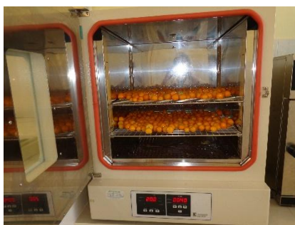
Secado (Temperatura: 20°C; Tiempo: 40 min)
