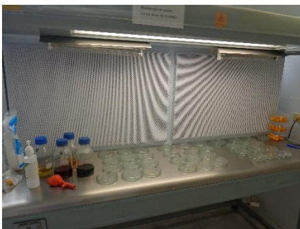
Cámara de flujo laminar
